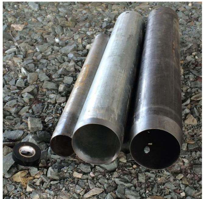
Figure 3 : Comparaison des tubes d'échantillonnage. De gauche à droite : tube shelby MTQ, tube de grand diamètre à paroi mince et tube de grand diamètre à paroi épaisse
